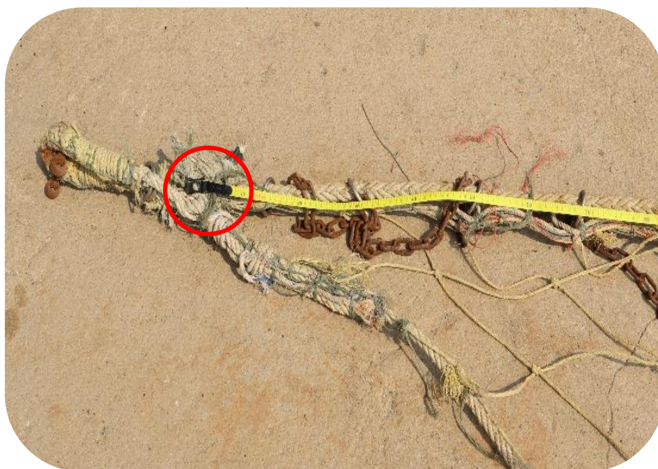
ภาพที่ ๑๑ จุดเริ่มต้นการวัดความยาวคร่าวล่าง (บริเวณหูวน จุดที่เนื้อวนเย็บมาดกับเชือกคร่าวล่าง)
