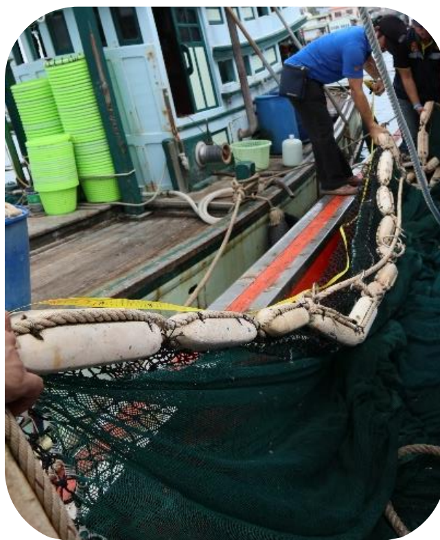
ภาพที่ ๕๘ การวัดความยาวคร่าวบนจากหุวนด้านหนึ่งไปยังหุวนอีกด้านหนึ่ง
