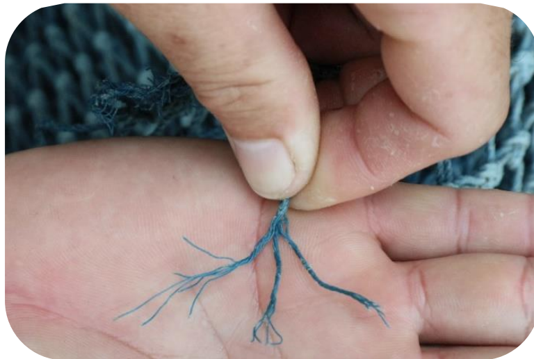
ภาพที่ ๑๙ ลักษณะของเนื้ออวนกันถุง ๑ เส้น ที่คลี้ออก
