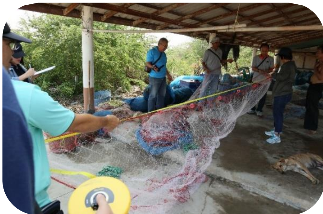
ภาพที่ ๖๓ การวัดความยาวคร่าวบนของอวนติดตา
