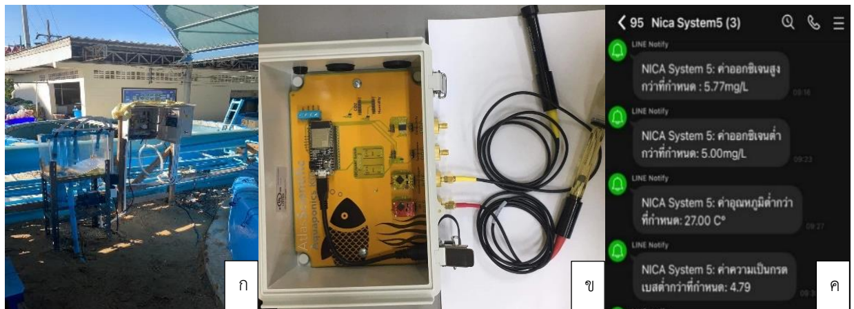
ภาพที่ 12 อุปกรณ์การตรวจสอบคุณภาพน้ำ การแสดงผลและการแจ้งเตือน
