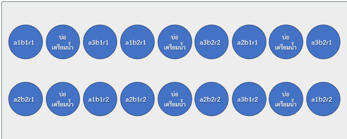
ภาพที่ 3 ผังการทดลองแบบ 3x2 แฟคทอเรียล โดยแผนการทดลองแบบสุ่มสมบูรณ์ของปัจจัยการเพิ่มอากาศ (a) ปัจจัยความหนาแน่น (b) และซ้ำของชุดการทดลอง (r) ในบ่อคอนกรีตกลมขนาดเส้นผ่านศูนย์กลาง 2.5 เมตร ในอาคารโรงเพาะฟักของศูนย์วิจัยและพัฒนาการเพาะเลี้ยงสัตว์น้ำจืดชลบุรี
