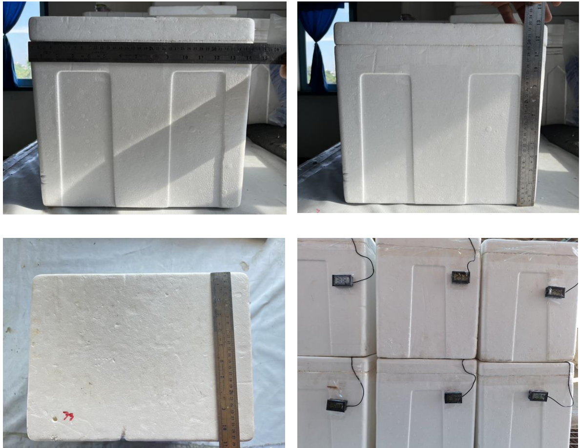
ภาพที่ 2 กล่องโฟมขนาด 28x36x33 เซนติเมตร หนา 2 เซนติเมตร และการติดตั้งเทอร์โมมิเตอร์ดิจิตอล
