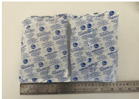
ภาพที่ 4 ถุงเจลเก็บความเย็น ขนาด 13x18 เซนติเมตร น้ำหนัก 500 กรัม
