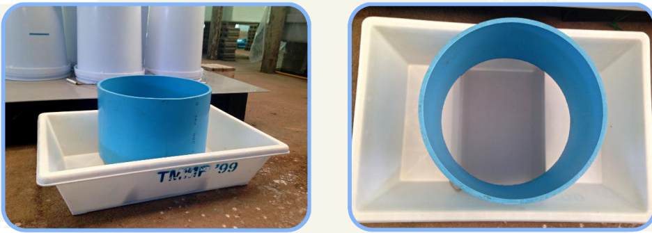
ภาพที่ 30 กระบอกกรองกรด้วยผ้ากรองในลอนขนาดช่องตา 90 ไมครอน
