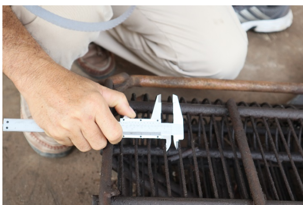
ภาพที่ ๖๗ แสดงภาพวิธีการวัดระยะห่างซี่คราด
