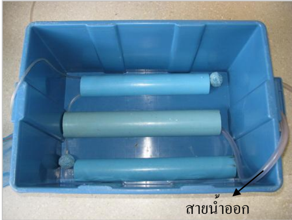
ภาพที่ 1 วางหัวทรายและสายน้ำออกระบายน้ำทิ้ง
