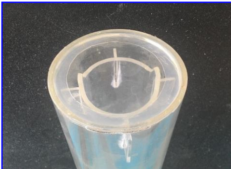
การดัดแปลงปลายท่อส่งน้ำด้านบน และขนาดท่อครอบ เพื่อสร้างสุญญากาศ
