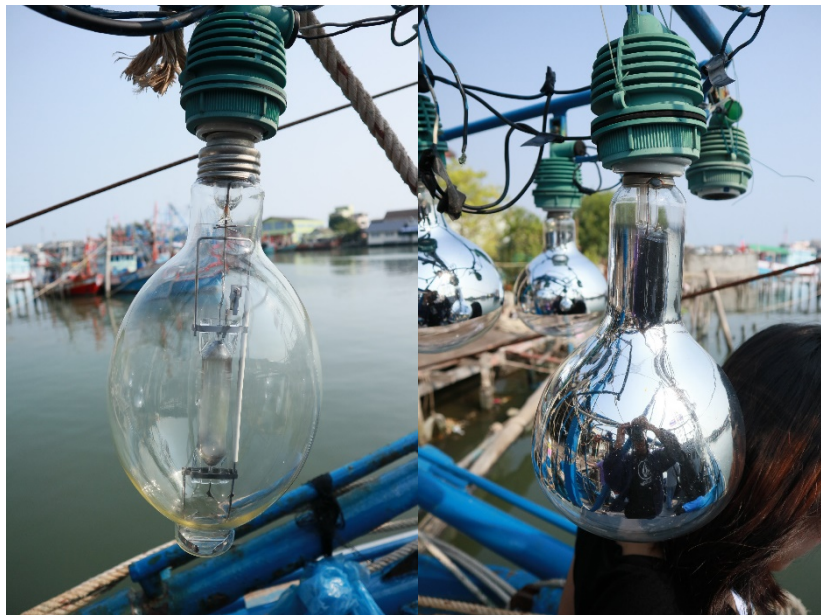
ภาพที่ ๕๐ แสดงภาพหลอดไฟที่ใช้ในการทำการประมงอวนครอบหมึก
