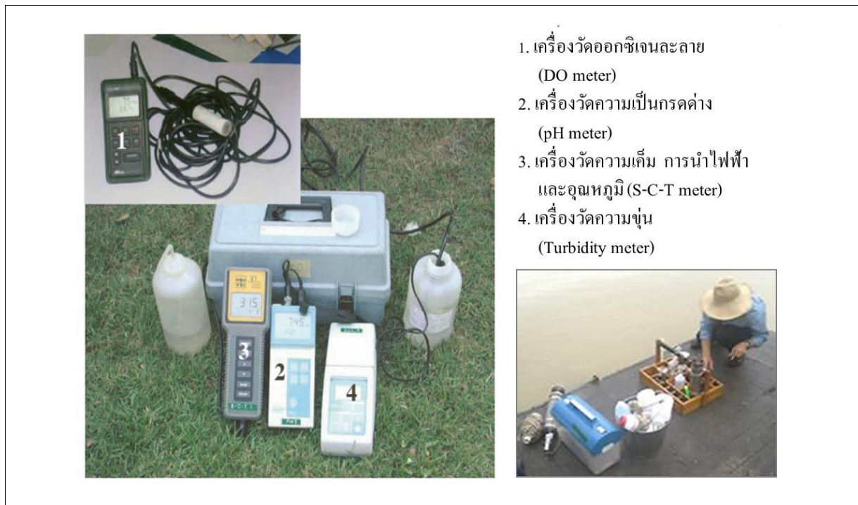
ภาพที่ 3 ตัวอย่างเครื่องมือตรวจวัดคุณภาพน้ำภาคสนามที่นำไปใช้ปฏิบัติงานการสืบหาสาเหตุ (ถ้ามี) หรือชุดอุปกรณ์ตรวจวัดปริมาณออกซิเจนละลายซึ่งอาจเป็นชุดทดสอบภาคสนาม (test kit) หรือชุดอุปกรณ์ที่จัดเตรียมจากห้องปฏิบัติการ
