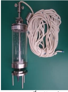
1. กระบอกเก็บตัวอย่างน้ำ แบบ Kemmerer
