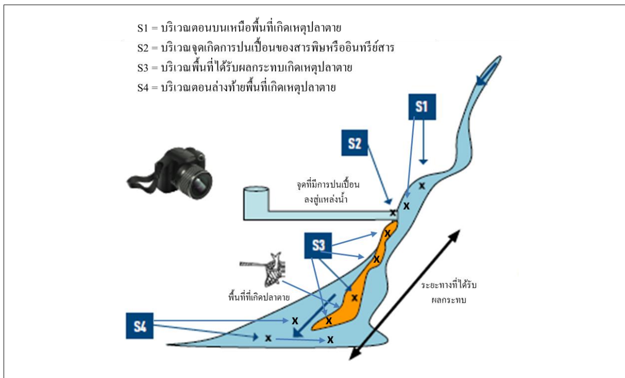
ภาพที่ 4 ตัวอย่างแผนที่แสดงจุดสูมตัวอย่างน้ำเพื่อเปรียบเทียบและประมาณขอบเขตของพื้นที่ลำน้ำที่ได้รับ ความเสียหายในเหตุการณ์ปลาและสัตว์น้ำตายในพื้นที่แหล่งน้ำจืด (ดัดแปลงจาก Interpole, 2014)
