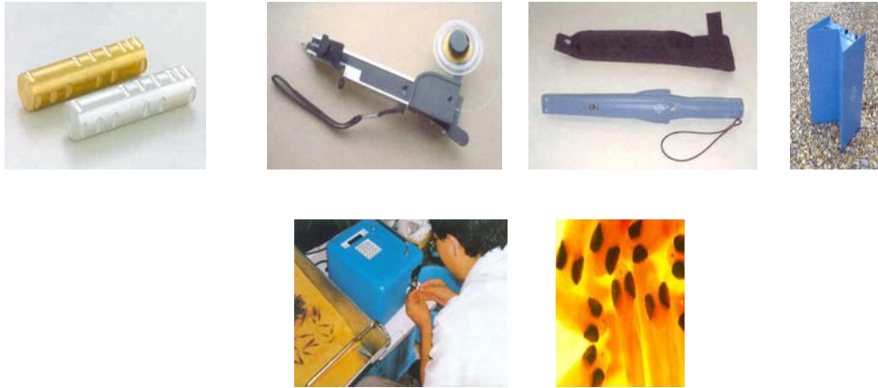
รหัส Coded wire tags เครื่องฝังรหัส เครื่องตรวจรหัส และการติตรหัสในตัวปลา
