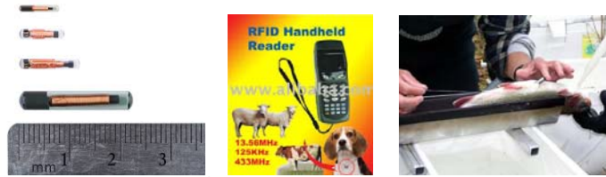
รหัส RFID tags เครื่องตรวจรหัส และการติตรหัสในปลา
